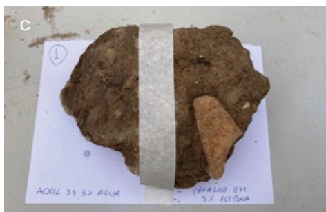
(a) Taller de probetas de consolidación sobre muestras de fragmentos de adobe procedentes de la superficie de Cerro Macareno. (b, c) Probeta recién consolidada mediante impregnación por goteo a partir de dos productos distintos, diferenciadas por testigo. Fotos: María Arjonilla Álvarez
