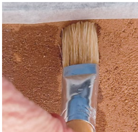
Pruebas de consolidación sobre revoco coloreado expuesto a intemperie realizado mediante arqueología experimental. Fotos: Francisco José García Fernández
